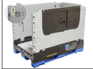
5. Birinci kısa yan paneli uzun yan panellerden çözün ve içeri katlayın. Kilit açma yerleri, kısa yan paneldeki kutunun içinde bulunur.
