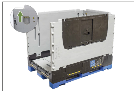
5. Erste kurze Seitenwand von den langen Seitenwänden entriegeln und einklappen. Die Entriegelungen befinden sich innen in der Box in der kurzen Seitenwand.
