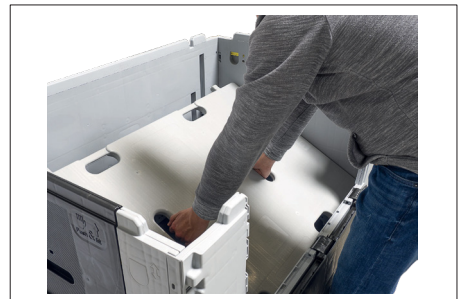
9. Die Zwischenlage muss immer zuerst in die Aufnahme der vorderen Wand eingelegt werden. Danach wird sie in die langen Aufnahmen der hinteren Wand eingelegt.
