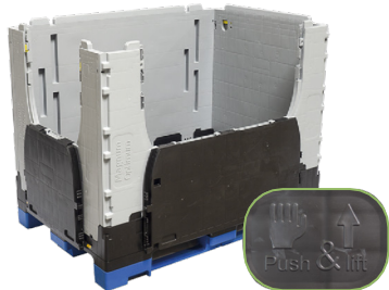
5. Zum besseren Beladen können die Entnahme- klappen geöffnet werden, dazu Entnahme- klappe nach innen drücken und dann nach oben ziehen.
